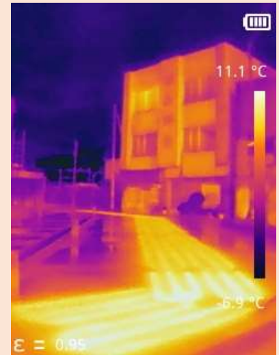
高熱伝導コンクリート放熱状況 2024.12.12
