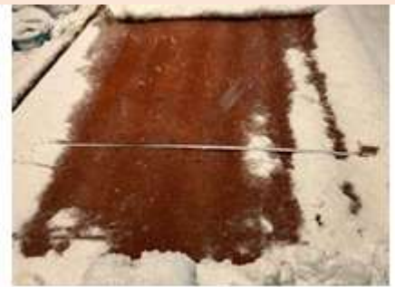
高熱伝導コンクリート：降雪深強度最大3.5cm/時間の状況
